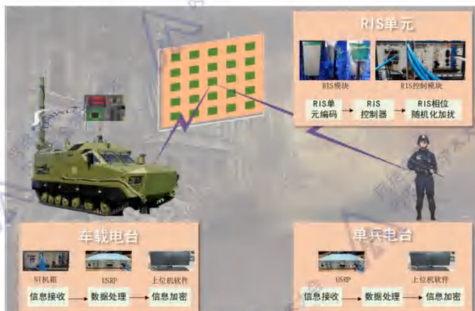
图 11 RIS 辅助的无线高速密钥生成与加密系统总体架构
