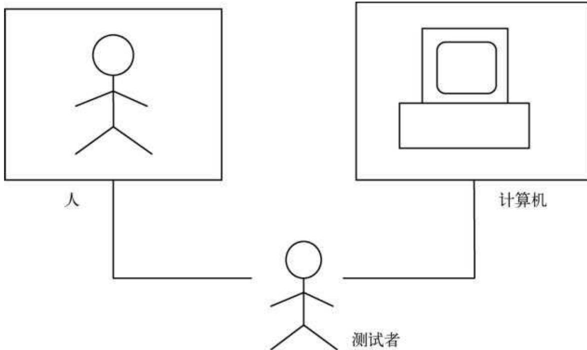
在这篇论文中，图灵提出了鉴别机器是否具有智能的方法，这就是人工智能领域著名的“图灵测试”。如图所示，其基本思想是测试者在与被测试者（一个人和一台机器）隔离的情况下，通过一些装置（如键盘）向被测试者随意提问。进行多次测试后，如果被测试者机器让平均每个测试者做出超过30%的误判，那么这台机器就通过了测试，并被认为具有人类智能
