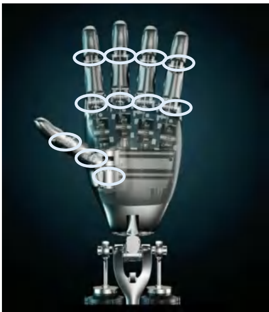
图10：特斯拉Gen 2共有11个自由度
