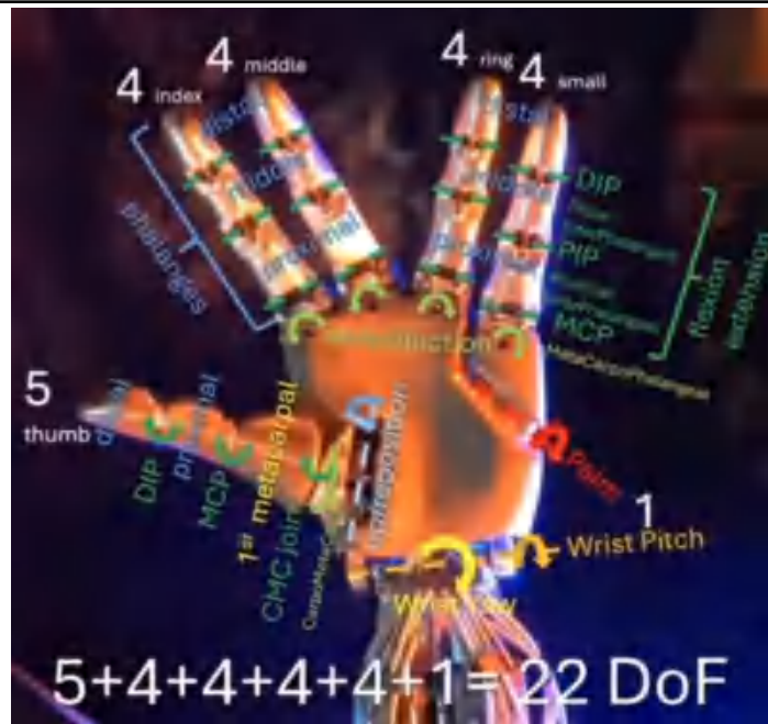
图11：特斯拉Gen 3共有22个自由度
