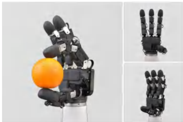
图46: Wonik Robotics 的 4 指灵巧手采用 XELA 的传感器
