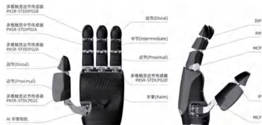
图50: DexH13 灵巧手集成一个相机、11 个触觉传感器模组
