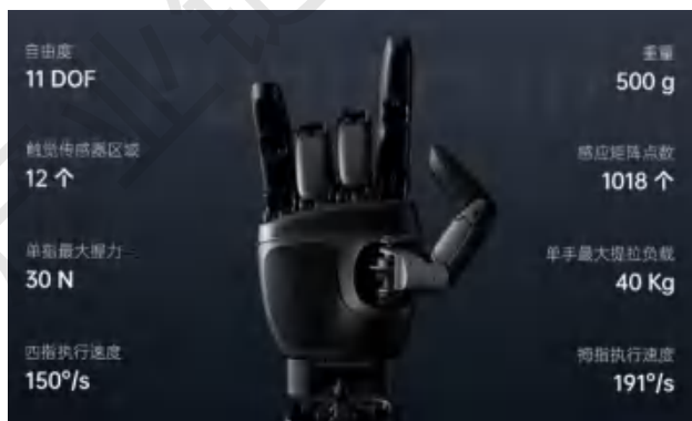
图42：普渡科技 DH11 灵巧手使用墨现触觉传感器
