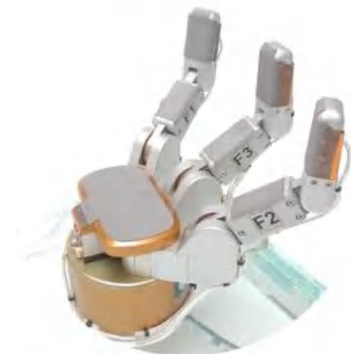
集成 PPS 触觉传感器阵列的 BarrettHand
