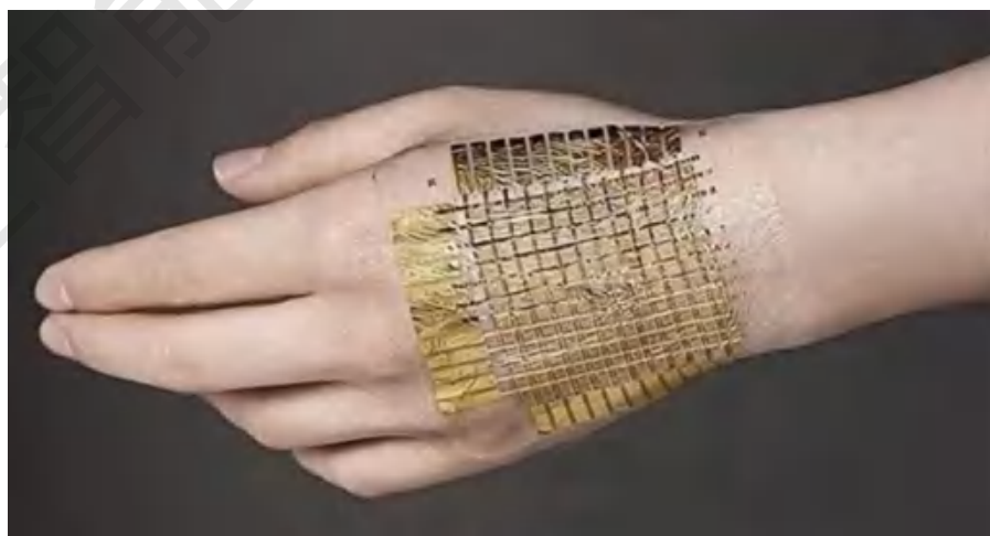
图20：柔性薄膜压力传感器可贴合于不规则的手背
