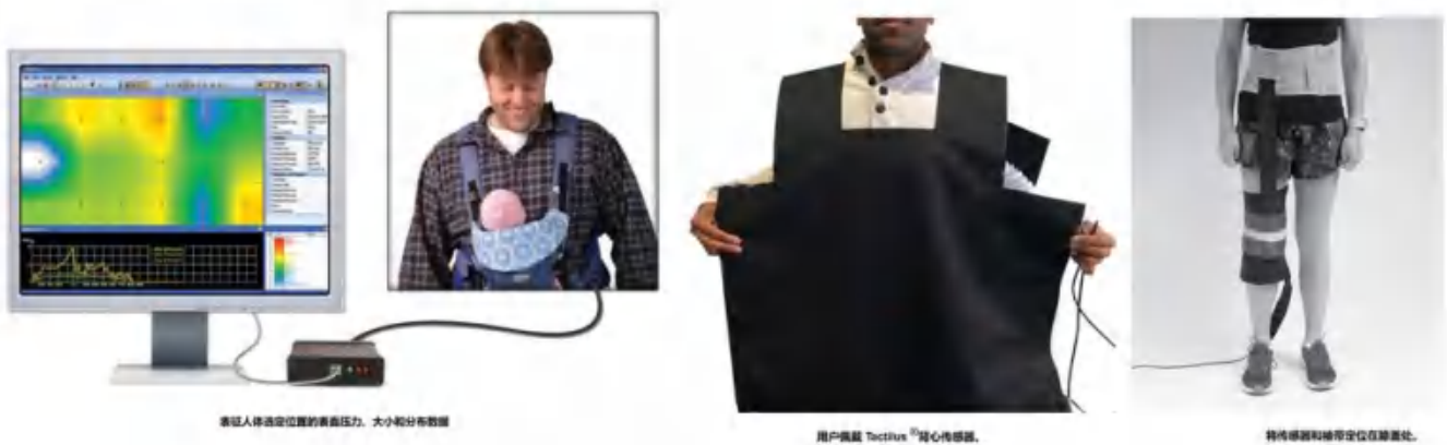
图33: SPI 的 Tactilus 表面触觉传感系统可用于两个接触面之间压力分布于大小的检测
