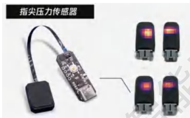
图41：墨现推出了指尖及指腹压阻触觉传感器
