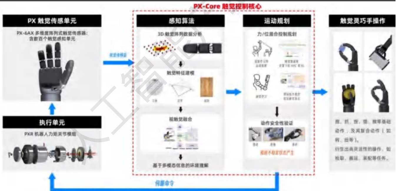
图49：灵巧手 DexH13 视触觉融合，采用电驱，具备测量法向力、摩擦力、分布力、力矩、材质、温度、滑动、回弹等 15 种触觉感知能力
